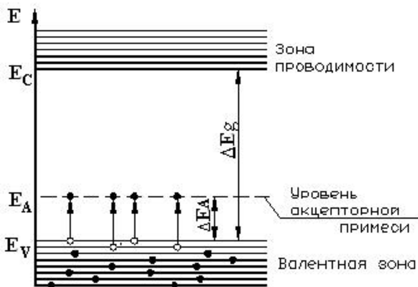
Рис. 3. Энергетическая диаграмма полупроводника p -типа с акцепторной примесью
